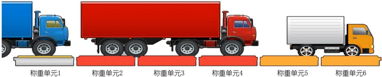
图1 模组整车式汽车衡结构示意图
