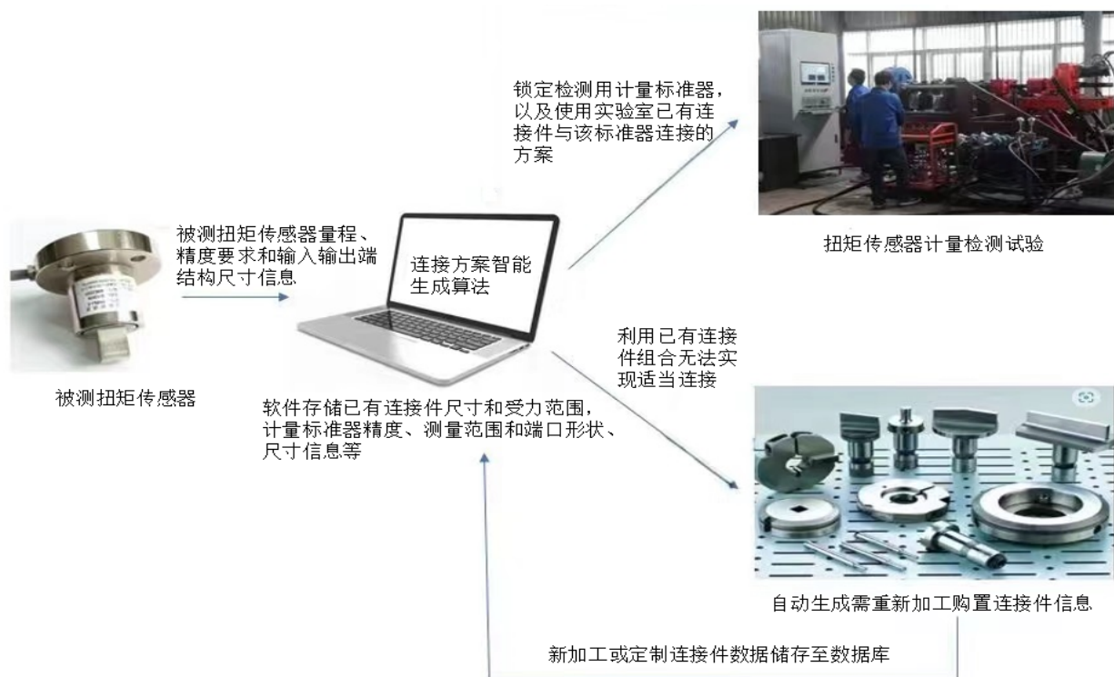
图4 扭矩连接件电子化管理示意图
