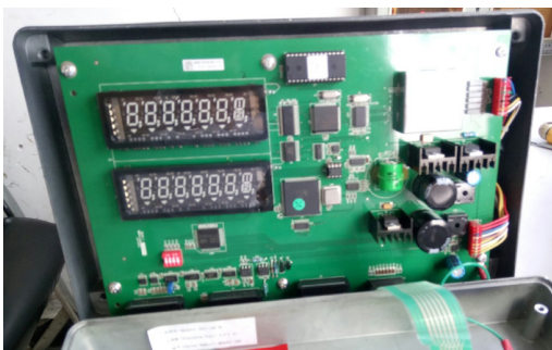
图17 显示仪表内部的正面
