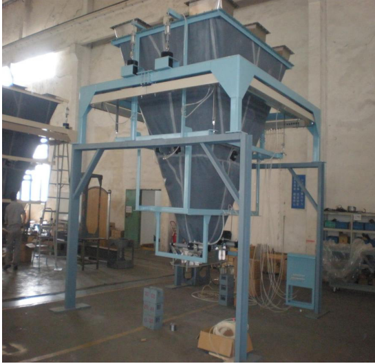
图8 橡胶行业炭黑粉料计量用炭黑秤外观图 [3]
