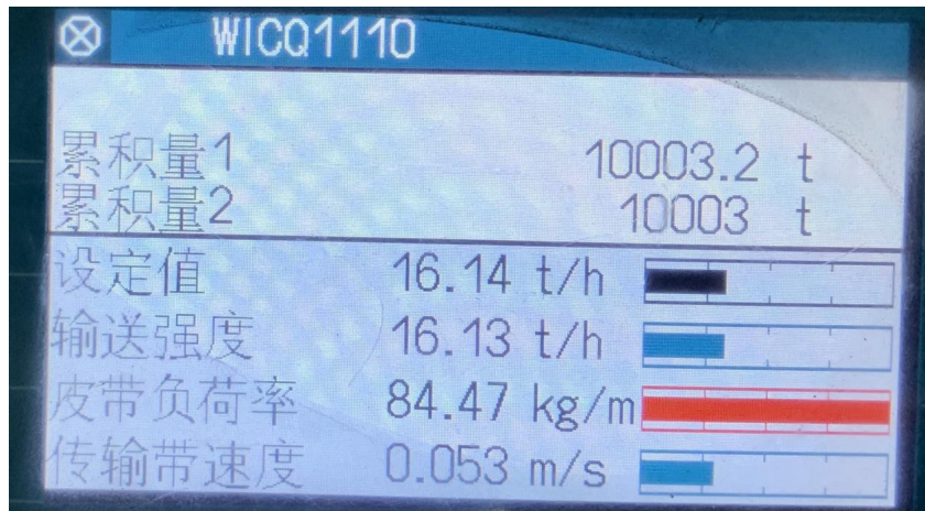
图2 截取的单台配料皮带秤显示画面
