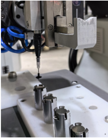
图7 电动真空吸笔和工作图
