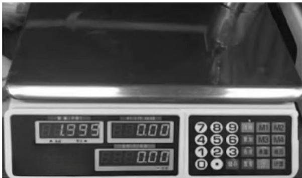
图3 检定分度值和显示屏显示实际分度值不相等
