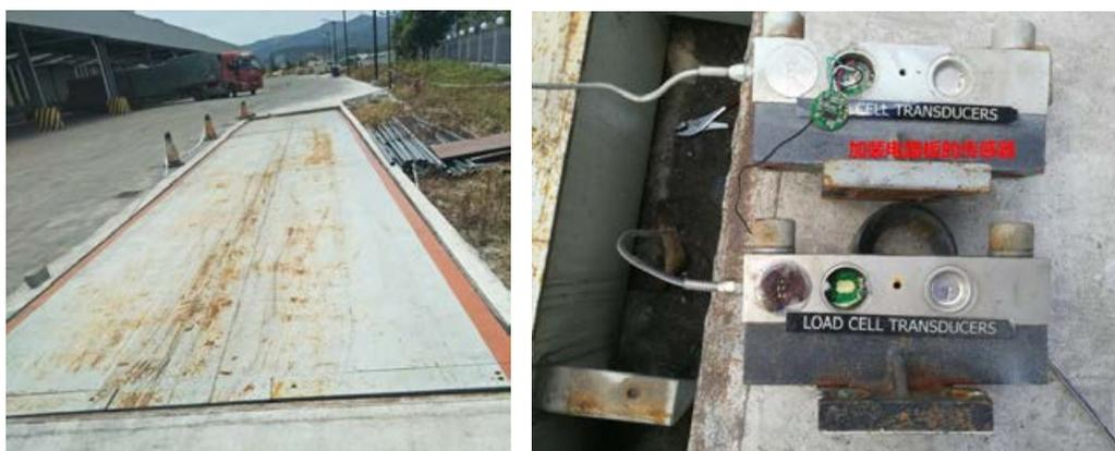
图 2 隐蔽式称重传感器内部被加装电路板
