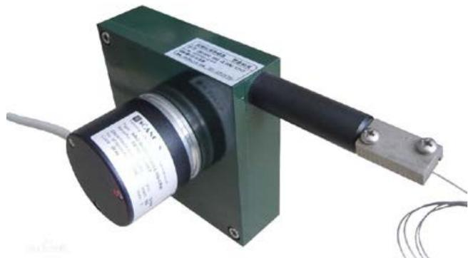
图 7. 某型织带张力传感器和位移传感器
