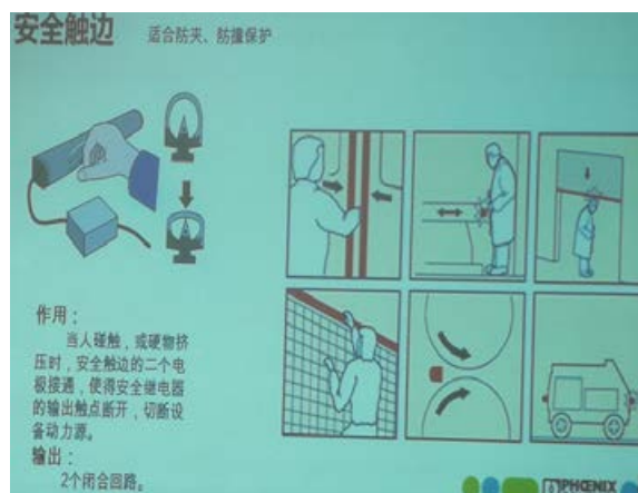
图 14 安全触边作用示意图
