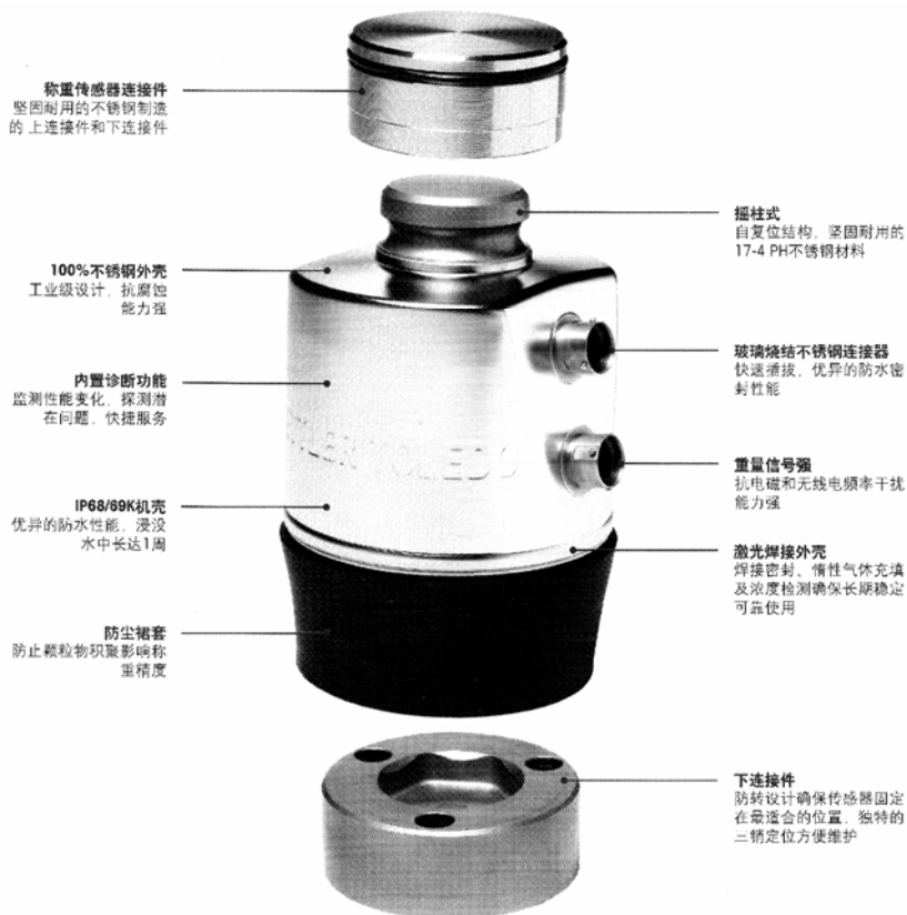
图 2 PDX 新型数字传感器的组成结构
