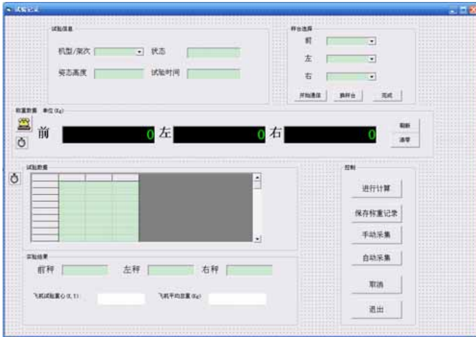
图7 三点支撑式飞机称重界面图
