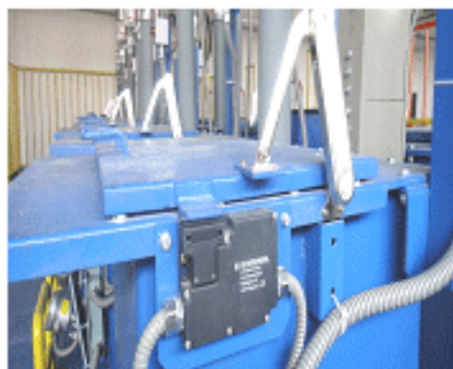
图 6 安全门锁在料斗秤中的应用
