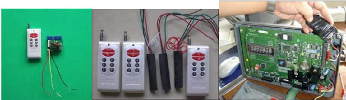
图 4 电子汽车衡作弊遥控器
