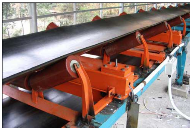
用于大块物料计量的悬浮式皮带秤
