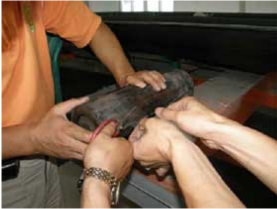
图3 试验人员正在托辊上绑铁丝
