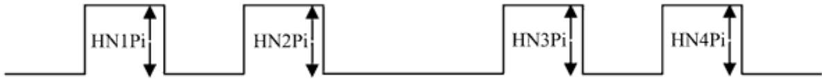
图 8 近端钢轨侧每一个测量子区间合成后的波形。图中, i=1, 2, 3, 4, 5 表示测量子区间序号
