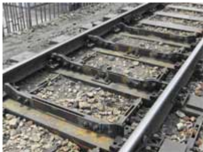
图 16 90 年代初，不断轨自动轨道衡（柱式传感器）
