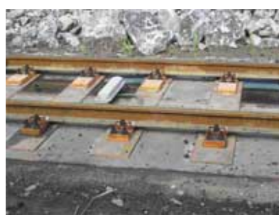
图 18 剪力传感器和重力（板式）传感器合成不断轨钢枕式无承载梁自动轨道衡图片
