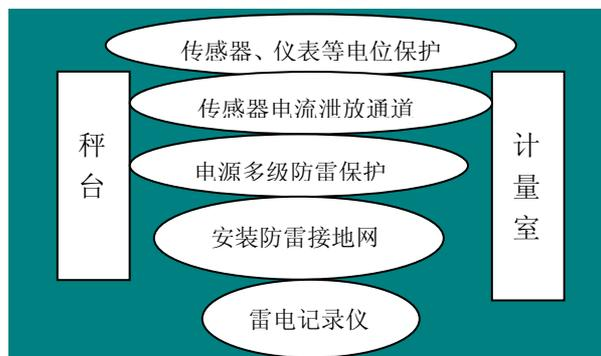
图 5 电子衡器防雷系统组成示意图
